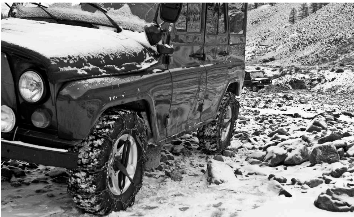
Рис. 19. Цепи на колёса для движения по бездорожью.
