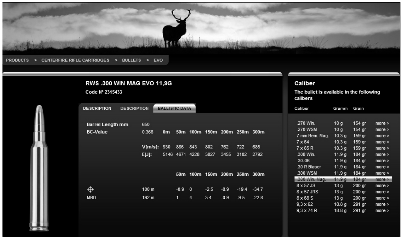
Рис. 5 Баллистические характеристики одного из патронов 300Win. Mag. Пристрелка – 100 м, длина ствола 650 мм, баллистический коэффициент пули 0,366, наиболее рекомендуемая дистанция выстрела – 192 м. (Данные официального сайта производителя http://rws-munition.de ).
